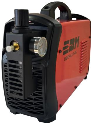
Встроенный воздушный фильтр-регулятор и манометр позволяют вам быстро и легко настроить оборудование. Всего через полминуты вы будете готовы приступить к резке. Кроме того, манометр позволит контролировать давление воздуха – рекомендуется поддерживать его в диапазоне от 0,5 до 0,6 МПа.
